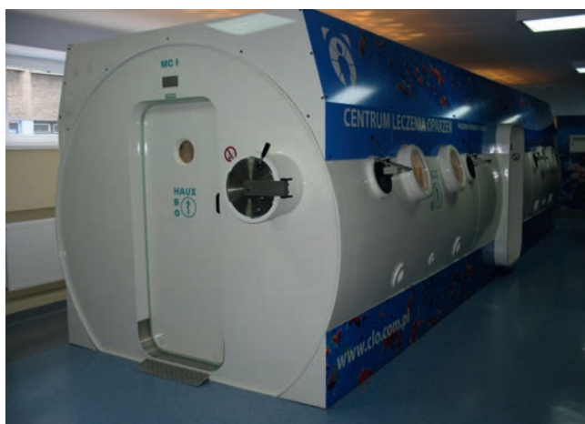
Ryc. 3. Komora wielomiejscowa HAUX Starmed 2500
